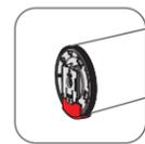
⚠ Älä poista kuljetuksen aikaista lukitusta ennen kuin kaihdin on asennettu. Välttyäksesi toimintahäiriöiltä varmista, että kaihdin on hyvin kiinnitetty ikkunaan ennen kuin säädät mekanismia.
